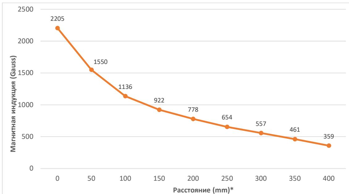
\* Измеряется от ленты сепаратора до конвейерной ленты
